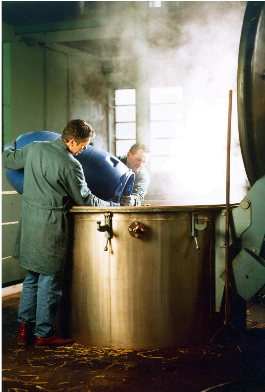
Bâtiment B, grand laboratoire. Remplissage de la cuve d'un extracteur de 3000 litres. (principe d'une infusion "géante"). Vers 1998.
