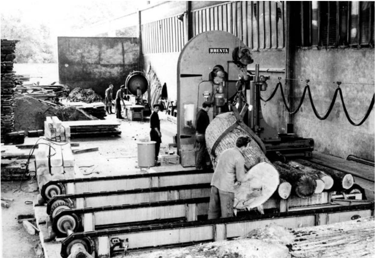
Vue intérieure de la scierie, scie à grumes, machine de tête Brenta. Photographie. (Collection particulière)
