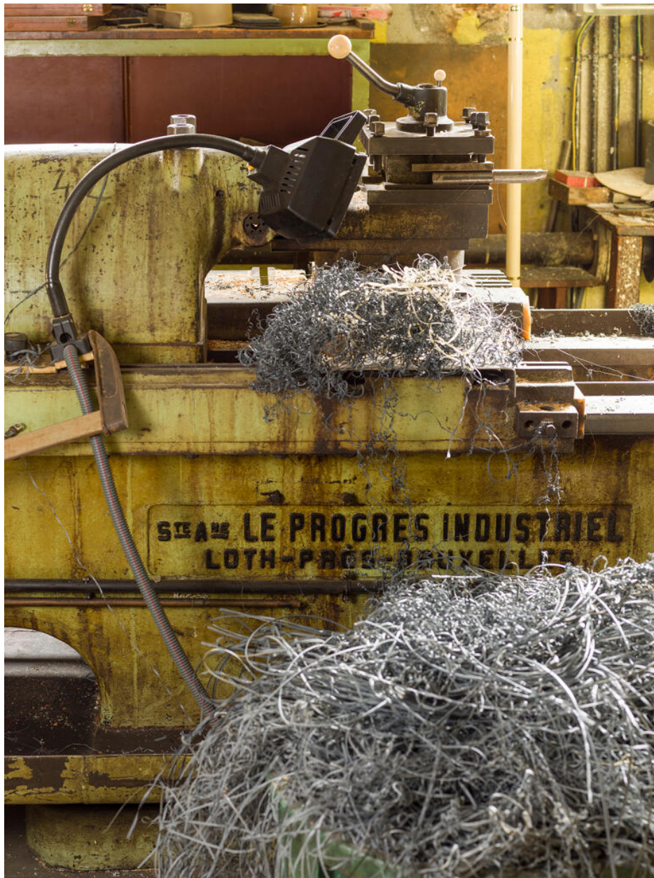
Atelier de mécanique générale (usinage). Détail de la plaque du fabricant : « Société Anonyme Le Progrès Industriel / Loth-Près-Bruxelles » du tour parallèle Le Progrès Industriel.
