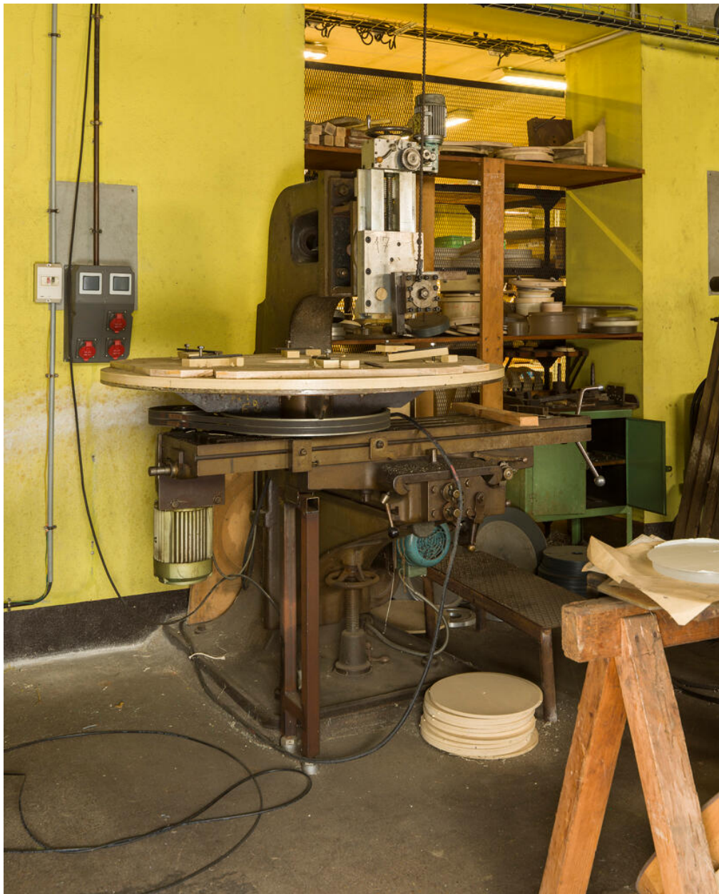
Atelier de mécanique générale (usinage). Transformation d'une fraise en tour vertical pour usinage de pièces en matières plastiques de diamètre supérieur à 1 m et inférieur 1,5 m.
