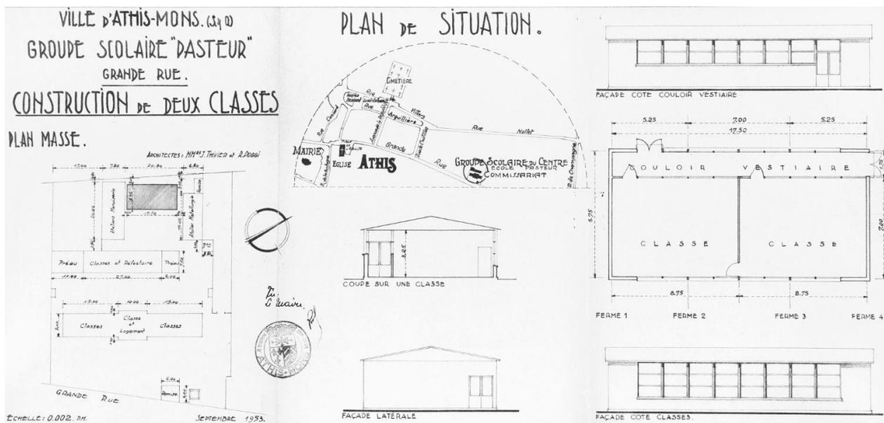
Construction de deux classes en préfabriqué, à l'arrière des bâtiments, entre les ateliers de menuiserie et de serrurerie : plan masse, coupe et élévations ; architectes Thivier et Poggi, septembre 1953.
