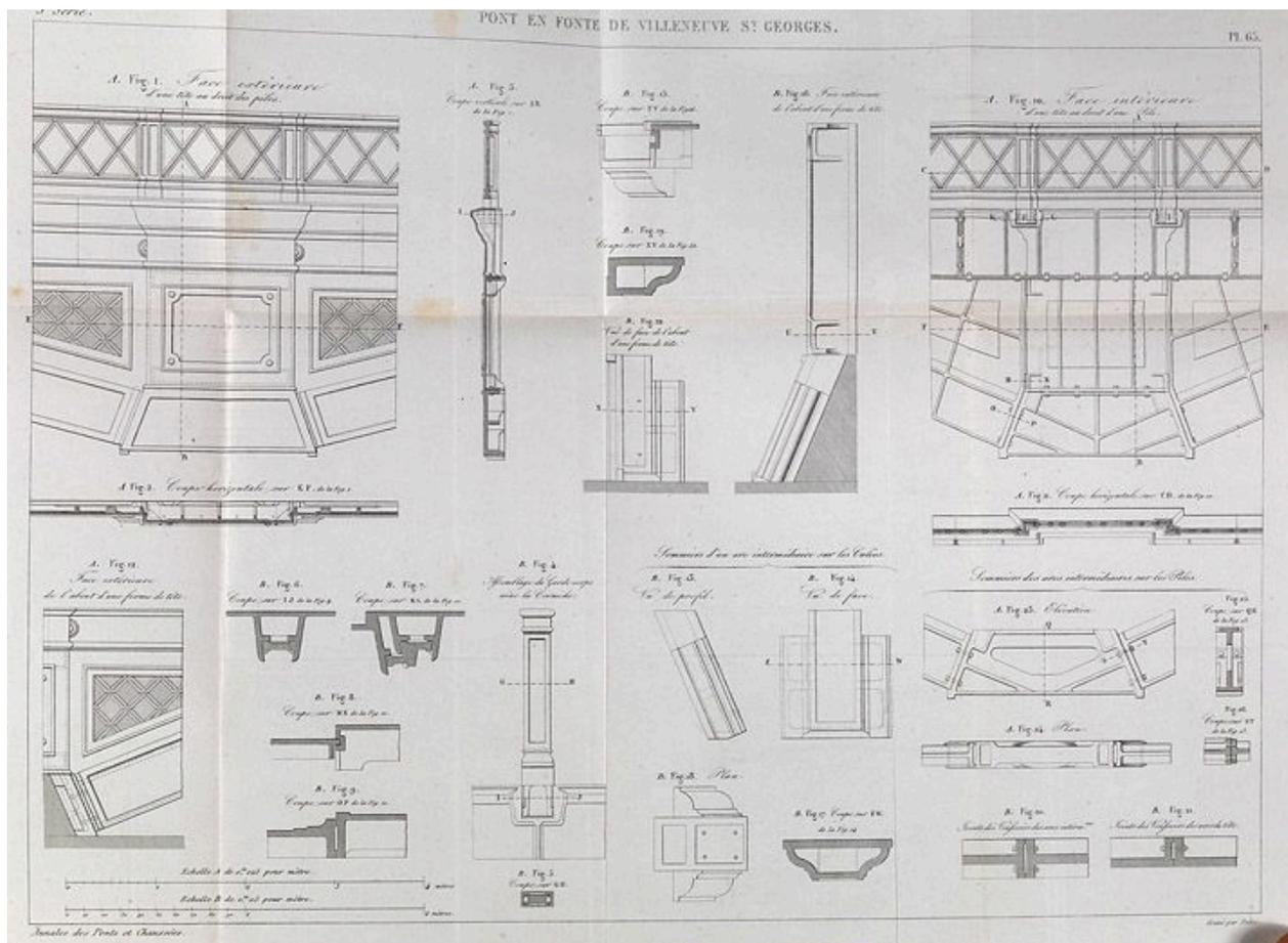
Villeneuve-Saint-Georges. Pont ferroviaire sur l'Yerres. Détails de construction du pont en fonte. Tiré de : Pont en fonte de Villeneuve-Saint-Georges. In Annales des Ponts et Chaussées, note 81, 1er semestre 1854, pl. 65.
