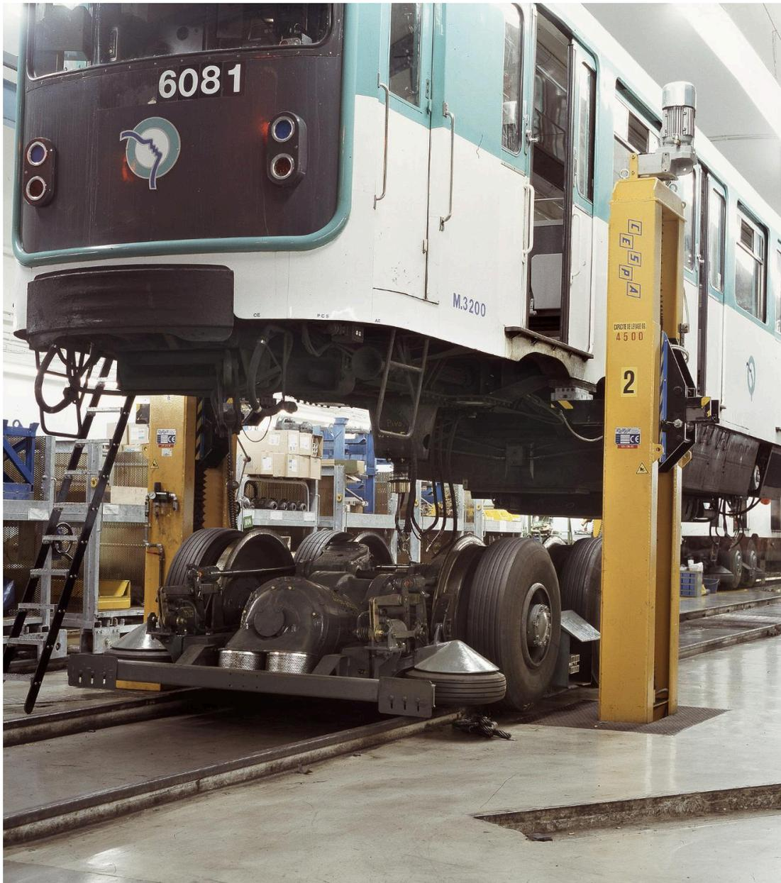
Echange de bogie pour révision générale. La batterie de vérins permet de dissocier le bogie de la caisse. Vue latérale.
