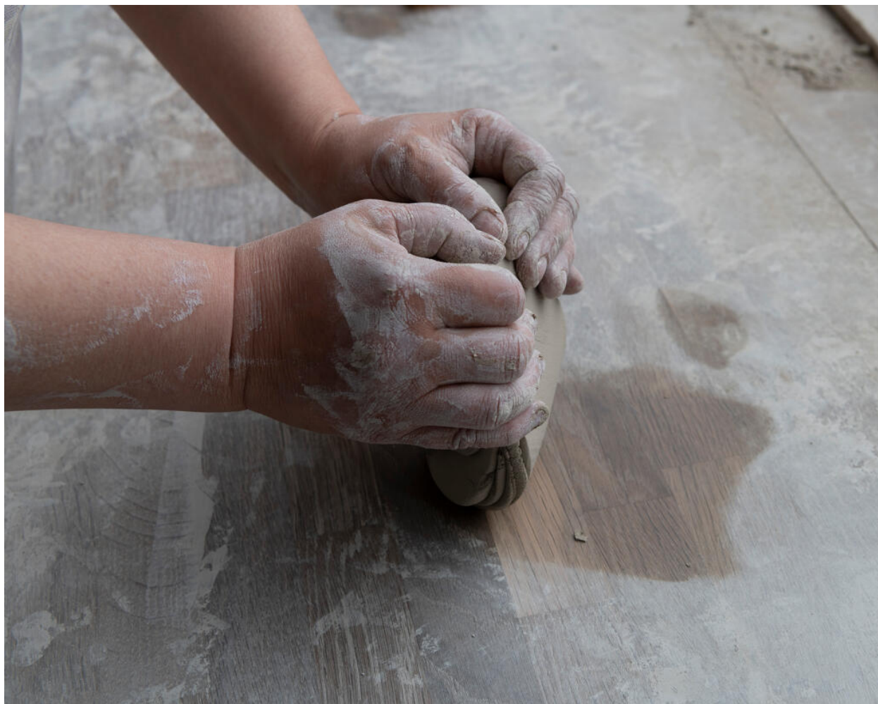
Atelier Danièle Wolff Céramiques. Battage de la terre, qui permet de chasser les bulles d'air et de l'homogénéiser.
