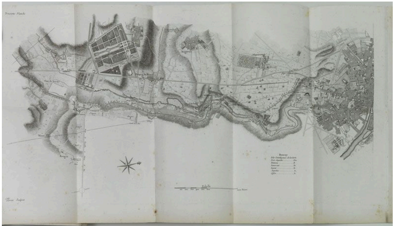
Planche représentant le projet de détournement des eaux de l'Yvette et de la Bièvre pour amener l'eau à Paris . Plans, 1765-1789. (Bibliothèque de l'Ecole de Nationale des Ponts et Chaussées, Ms.2567 )
