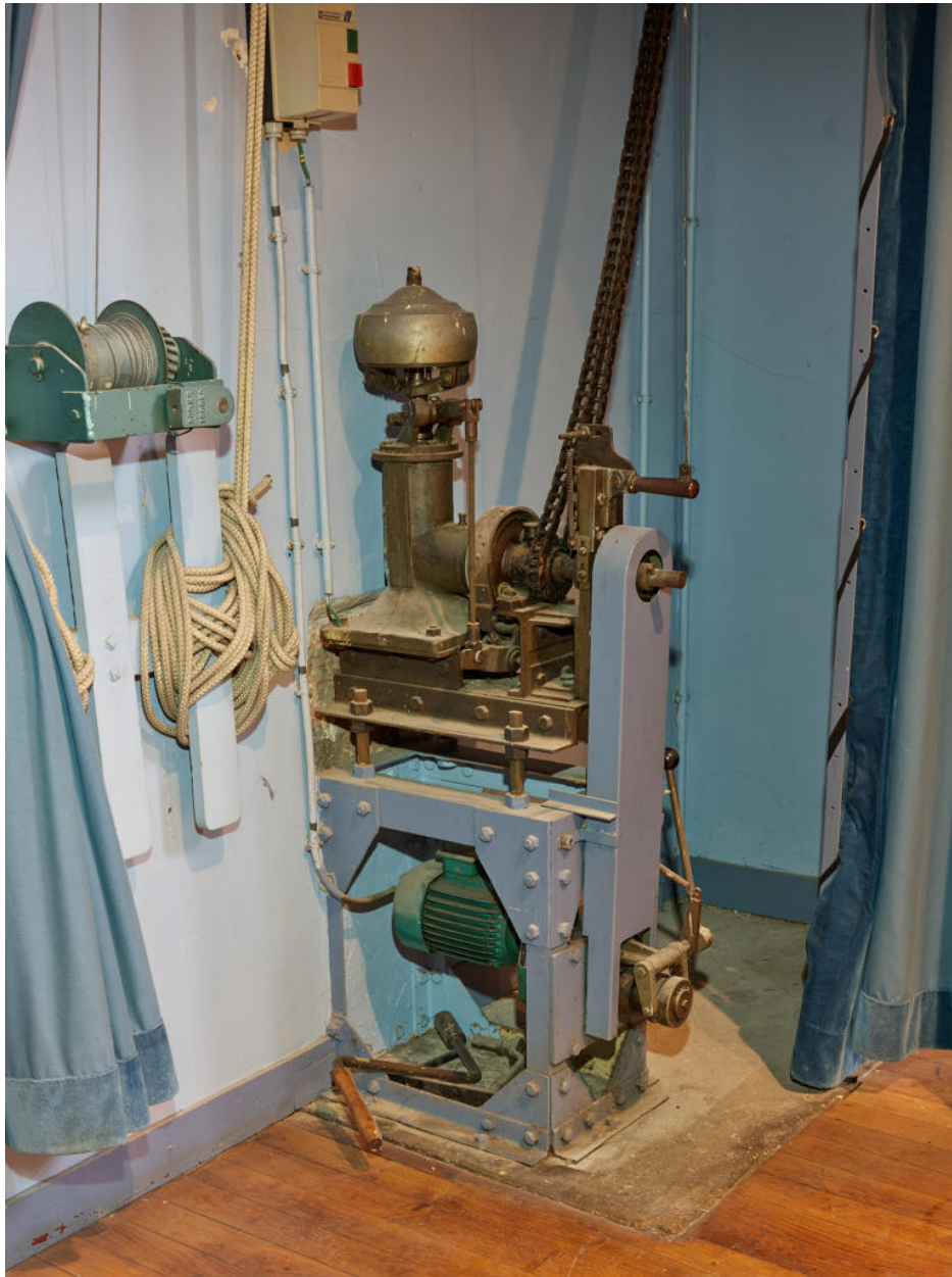
Machine de levage du rideau de fer, scène de la salle de spectacle.
