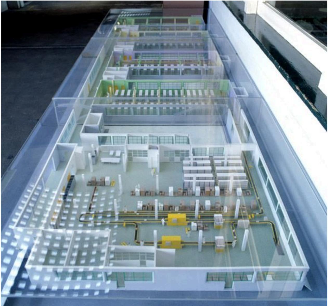
Aile sud (conditionnement) : maquette du "Marsupilami", système d'acheminement des produits desservant le site "Lucien-Auvert" et le site "Bel-Air".
