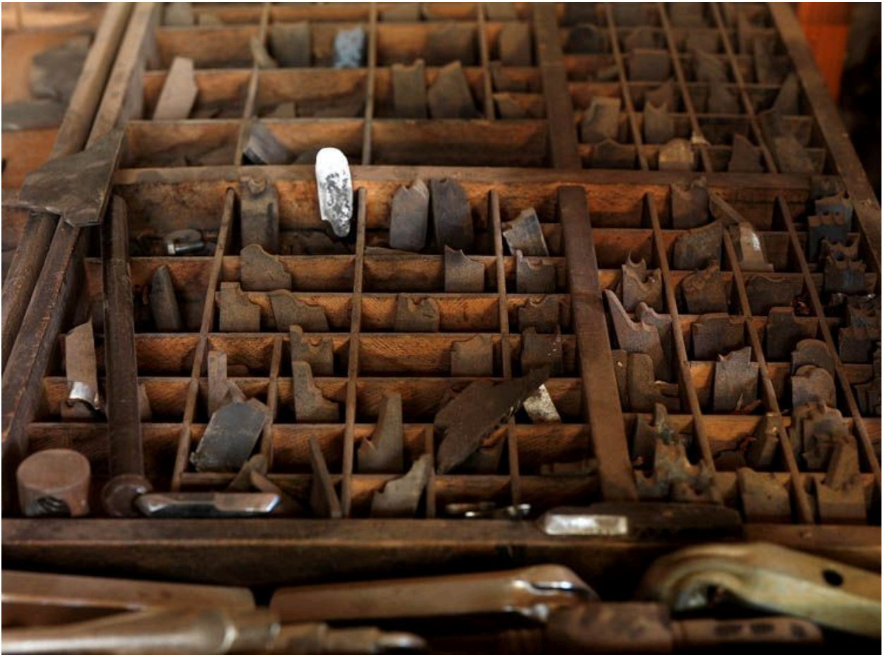
Casiers de rangement des formes utilisées pour la réalisation des moulures.
