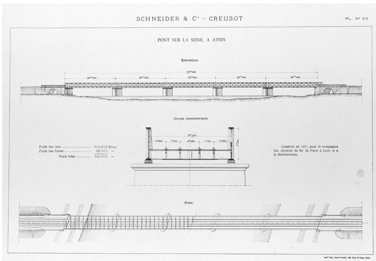
Elévation longitudinale, coupe transversale sur le tablier et plan ; Schneider et Cie, 1871.
