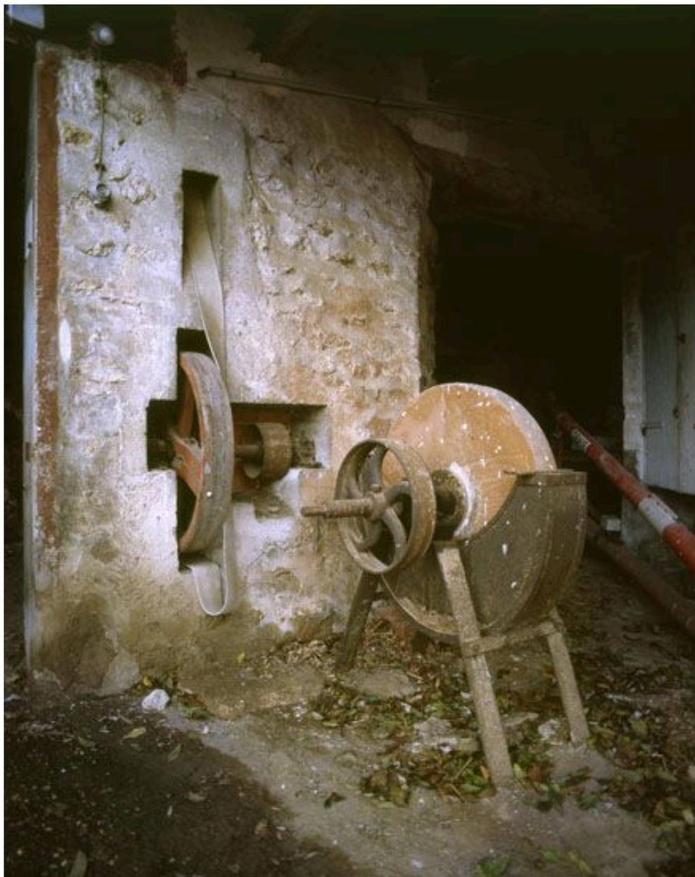
Meule et courroies de transmission pour l'actionner.
