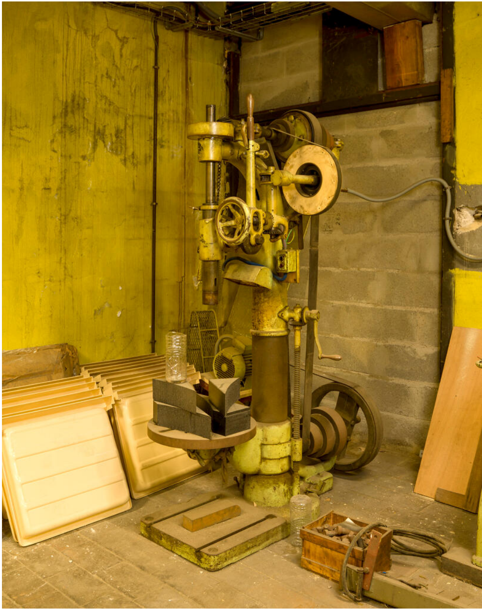
Magasin d'accessoires et de pièces détachées standards pour enceintes de confinement. Perceuse radiale (ou à colonne), transmission par courroie plate. Dommages de guerre.
