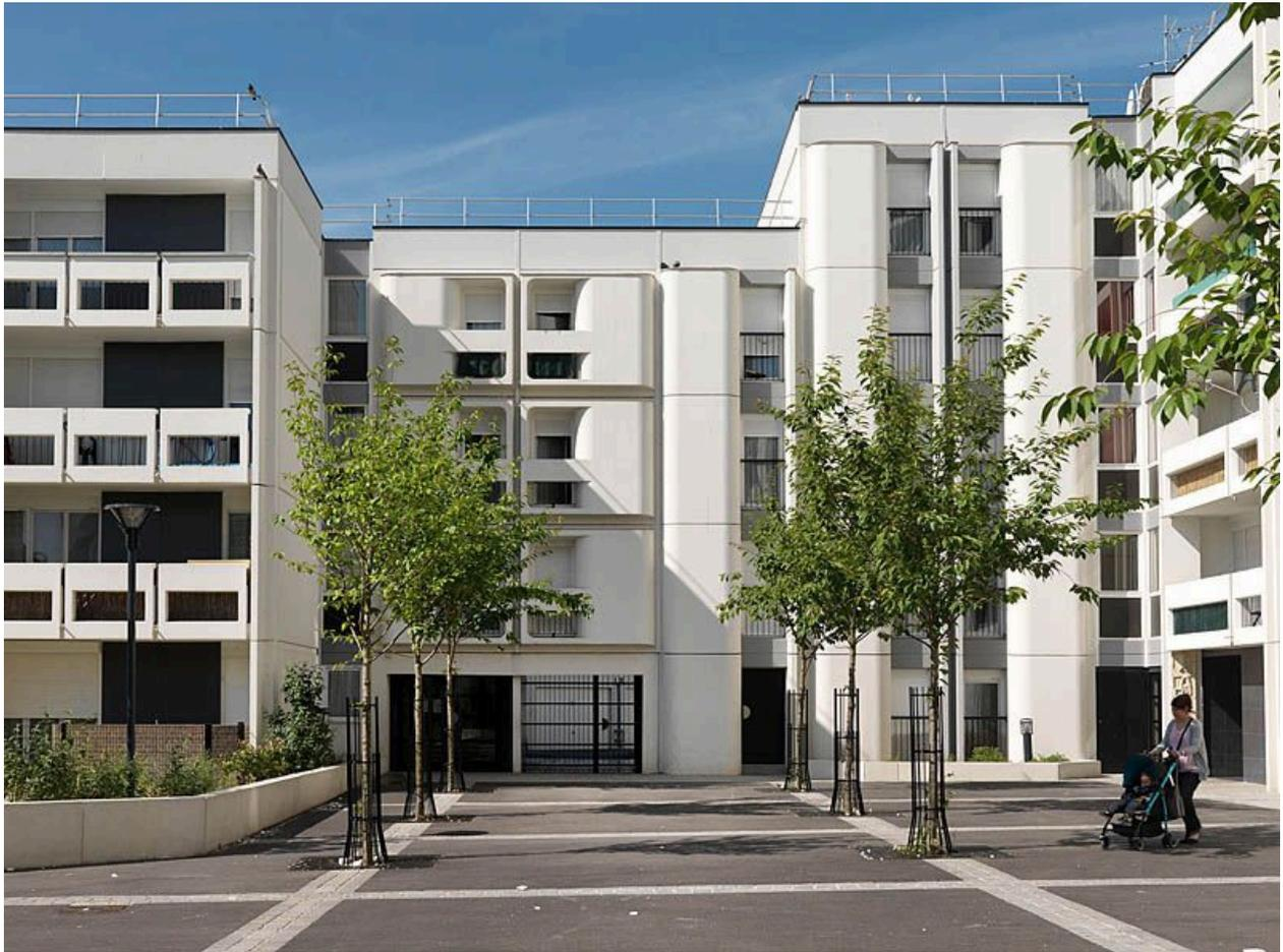
cité dite Résidence Pergaud. Parvis et entrée d'un groupe d'immeubles. L'ensemble des modules préfabriqués comportant des baies (loggias à 2 ou 3 éléments, fenêtres simples avec garde-corps métallique ou en béton) sont représentés.
