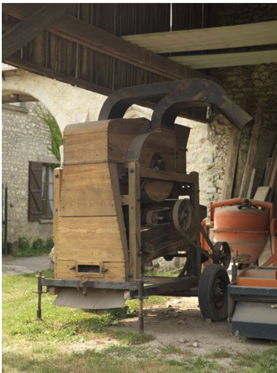
Nettoyant-séparateur à grains sous un hangar.
