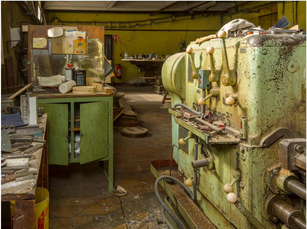
Atelier de mécanique générale (usinage). Tour parallèle Le Progrès Industriel. Leviers de la boîte de vitesse.
