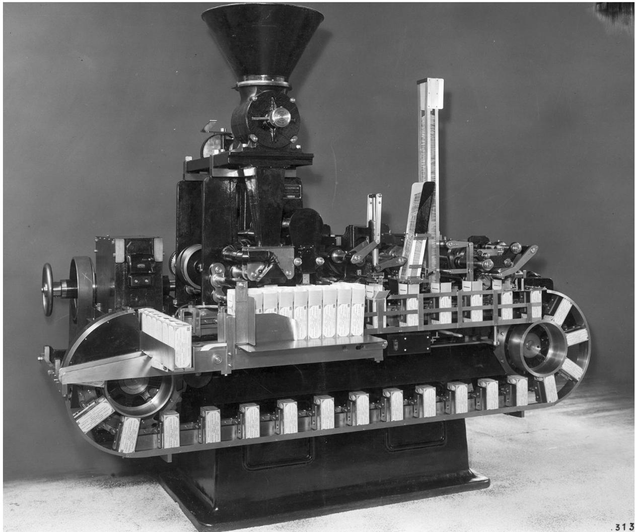
Machine Chambon installée au 2e étage du bâtiment principal, servant au conditionnement des boîtes de tisanes en vrac. En activité, elle était placée sous le grand entonnoir et était reliée par une chaîne à la machine fabriquant les boîtes.
