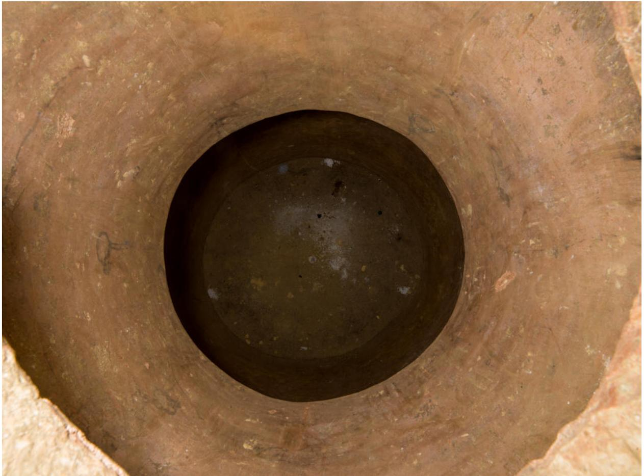
Intérieur d'un silo expérimental de 6 m<sup>3</sup> creusé en 1821. Enduit d'un mélange d'huile de lin, de cire d'abeille, d'oxyde de plomb et de brique pilée pour le rendre étanche.
