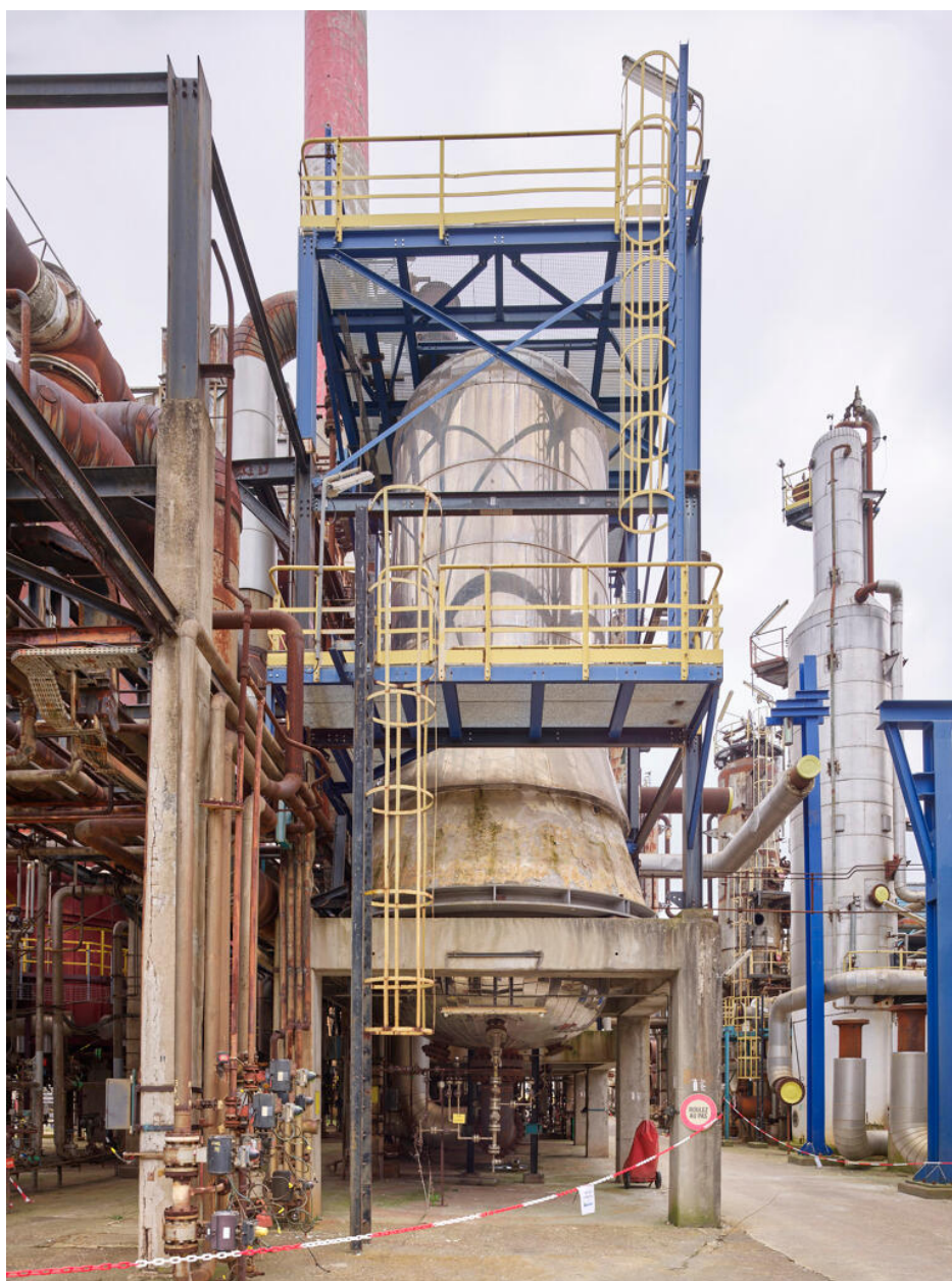
Unités Ouest - Reformeur catalytique (Unité 642). Au premier plan le réacteur 642 D8, à droite le stripper d' \text{H}_2\text{S} 642 C1.
