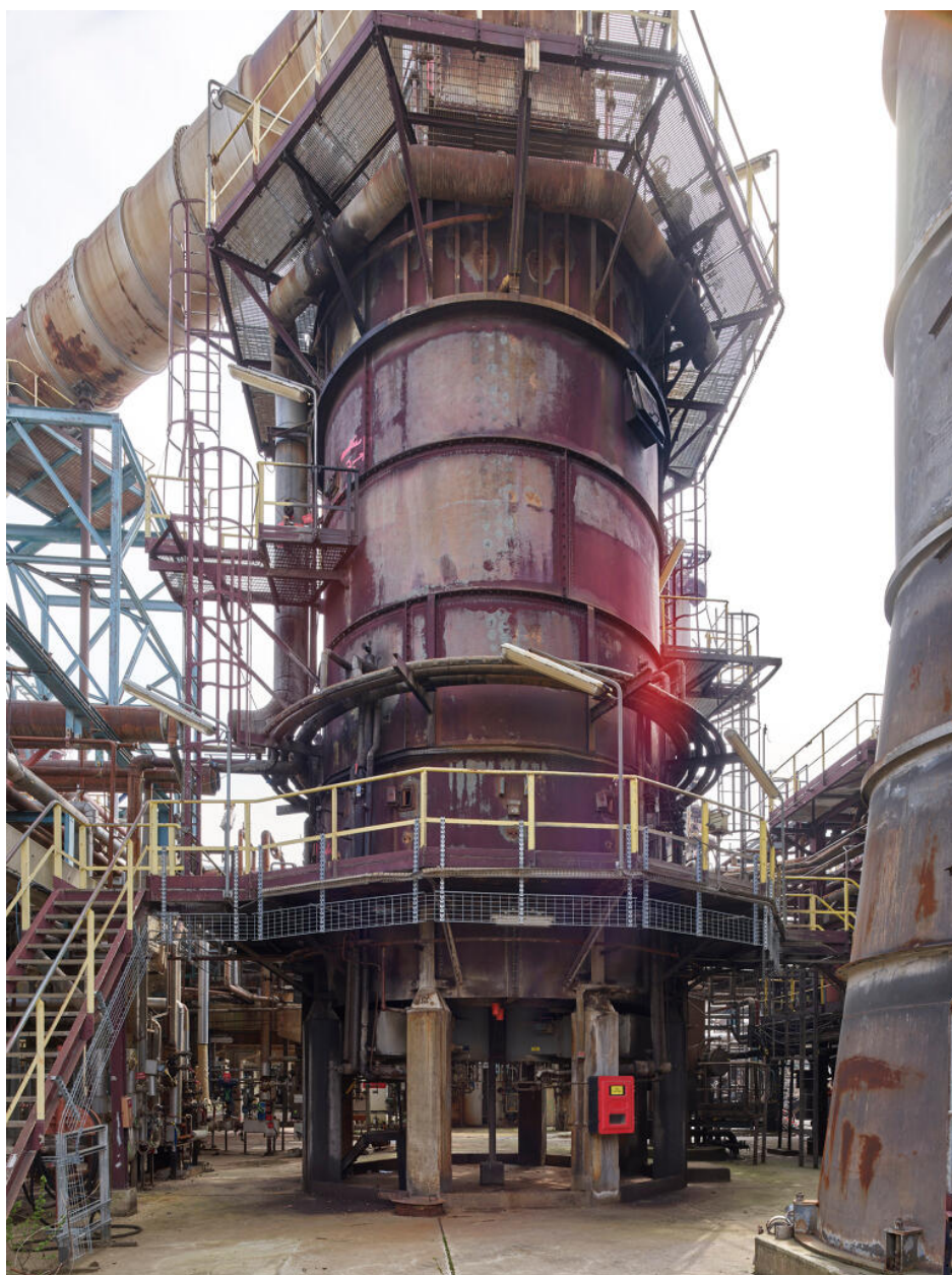
Unités Est - Zone du viscoréducteur (Unité 691). Vue du four de l'alkylation (Unité 761) situé sur l'unité du viscoréducteur.
