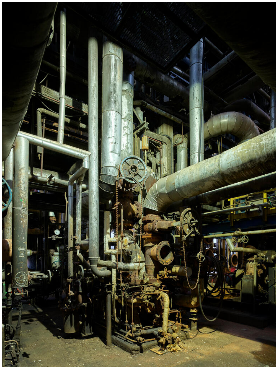
Unités Ouest - Zone de distillation (Unité 612). Turbopompe GT 7.
