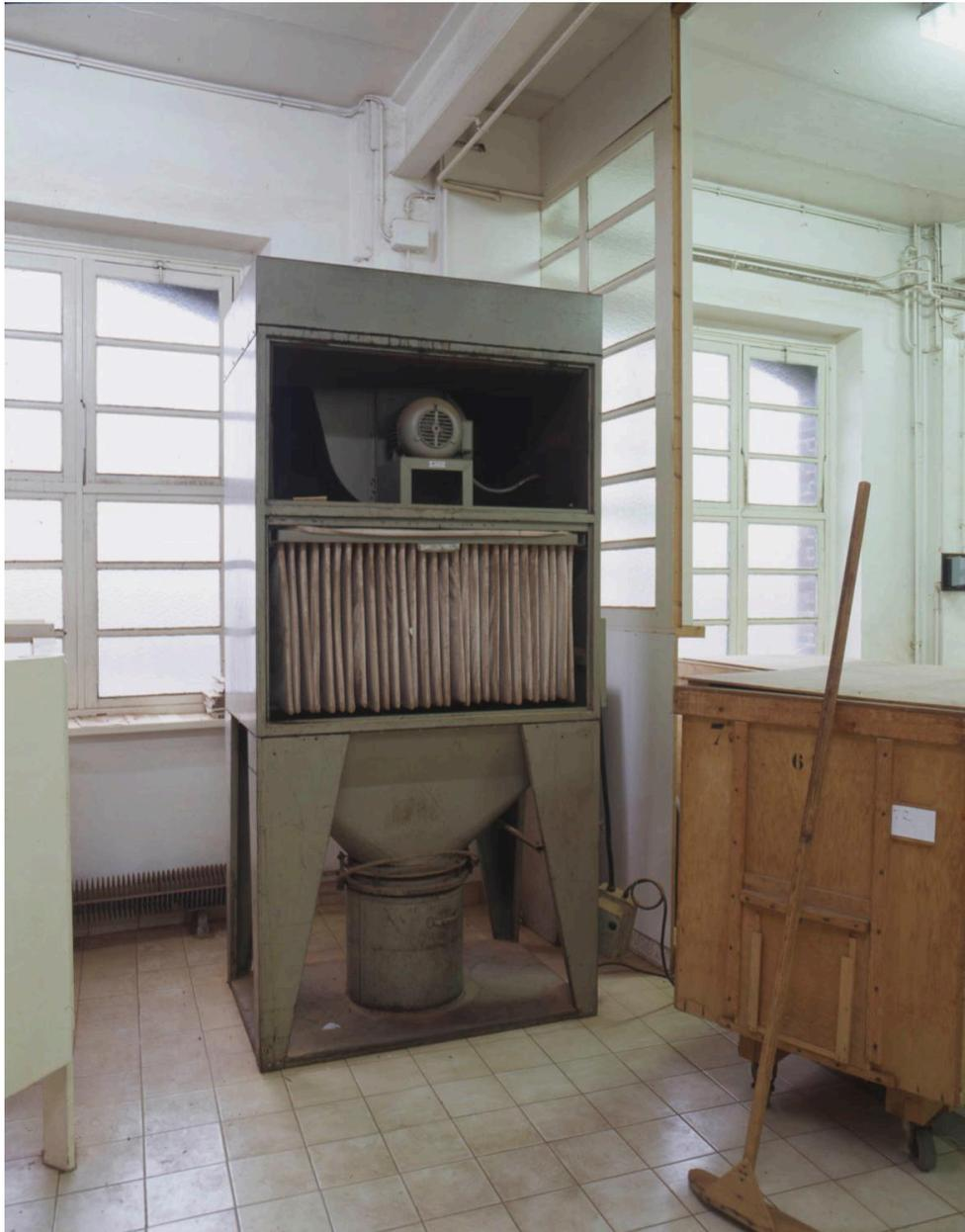
Filtre à poussière (non raccordé) placé au 2e étage du bâtiment principal. L'aspiration se réalisait de bas vers le haut.
