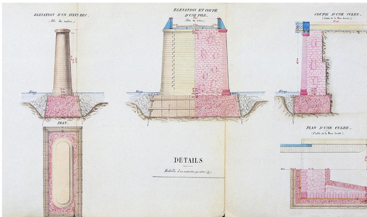
Plan dressé par l'ingénieur ordinaire E. Rousseau, Corbeil, 26 décembre 1860 : détails de l'élevation d'un avant-bec, de l'élevation et coupe d'une pile, de la coupe et du plan d'une culée.
