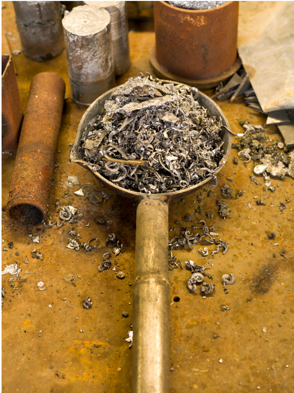
Chaudronnerie métallique. Copeaux de plomb destinés à la refonte, pour la fabrication d'écrans anti-radiations à l'intérieur des enceintes de confinement.
