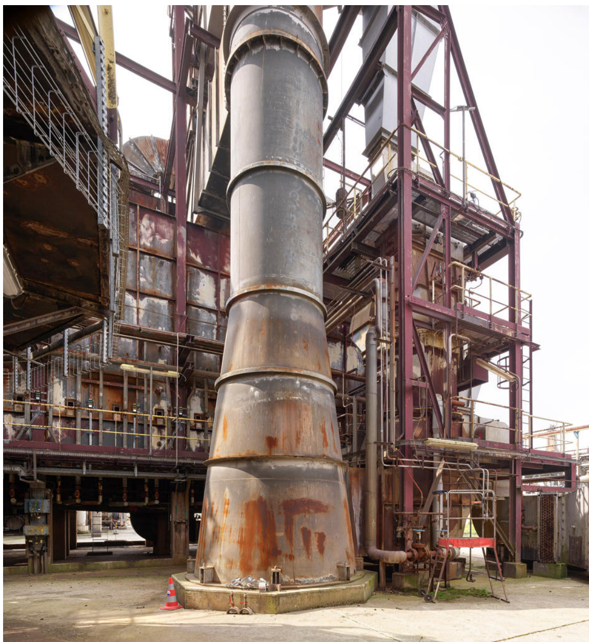
Unités Est - Zone du viscoréducteur (Unité 691). Four du viscoréducteur. Alimentation en air.
