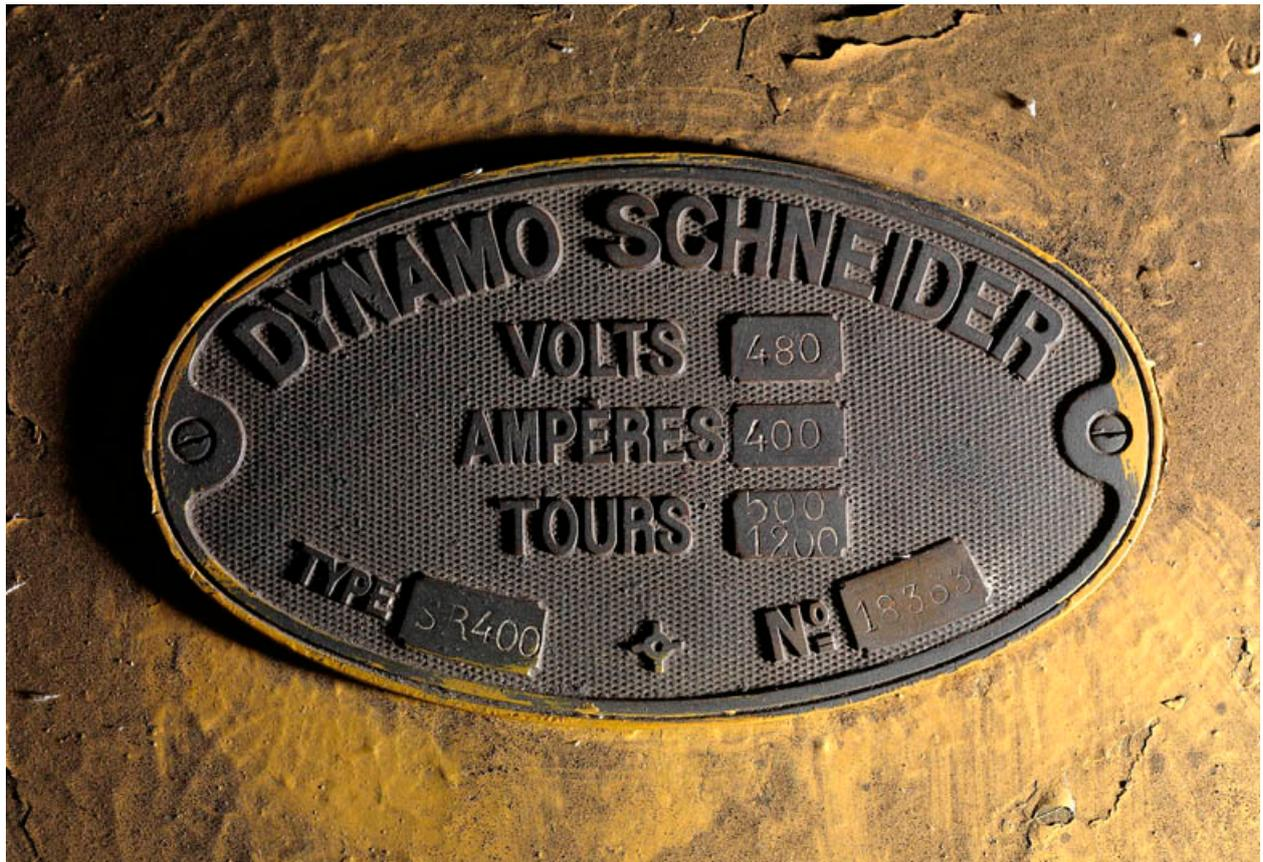
Plateforme d'essais. Entreprise Jeumont-Electric. Détail d'une plaque en métal avec l'inscription "Dymano Schneider" type SR400.
