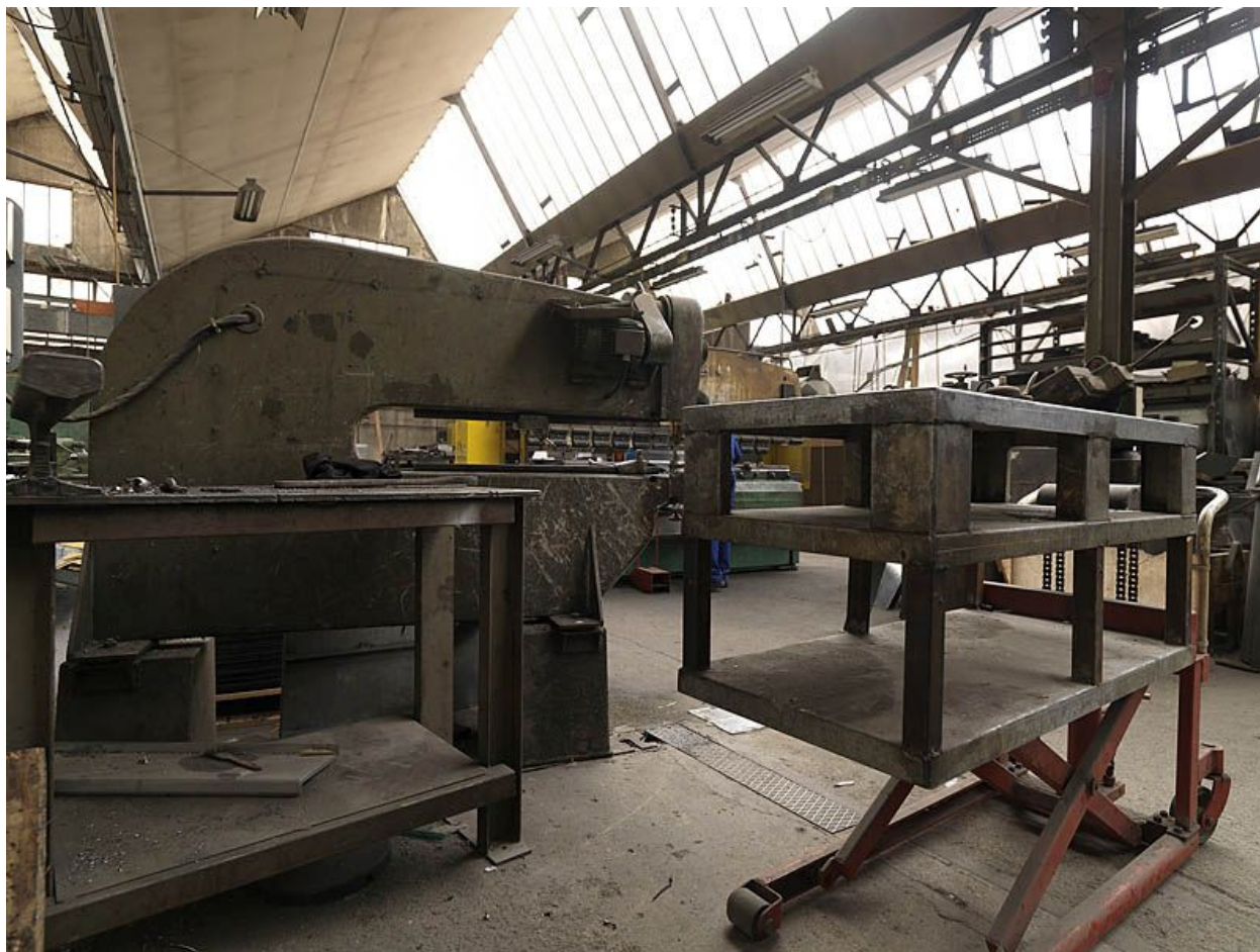
Intérieur de l'usine Bieth-Humbert avec machines à découper ou emboutir.
