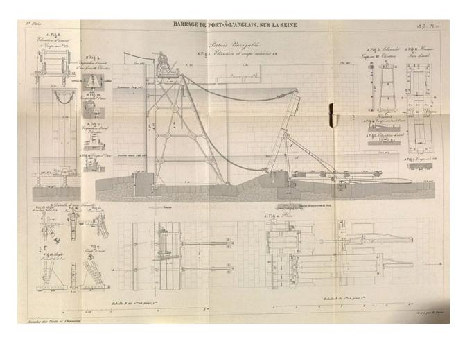
Alfortville, Vitry-sur-Seine. Barrage éclusé de Port-à-l'Anglais. Elévations et coupes.Tiré de : Nouvelle passe navigable établie en 1870 sur le barrage de Port-à-l'Anglais. Hausses mobiles supportant une retenue de 4 m / M. Boule. In Annales des Ponts et Chaussées, 2e semestre 1873, n° 42.
