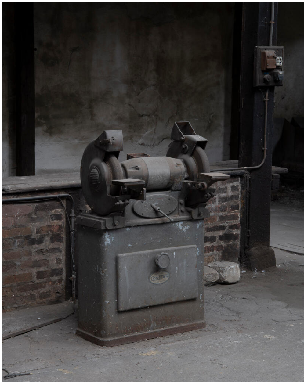
Intérieur de l'atelier des forges. Touret à meuleur "Moteurs Constant Outillage Électrique"
