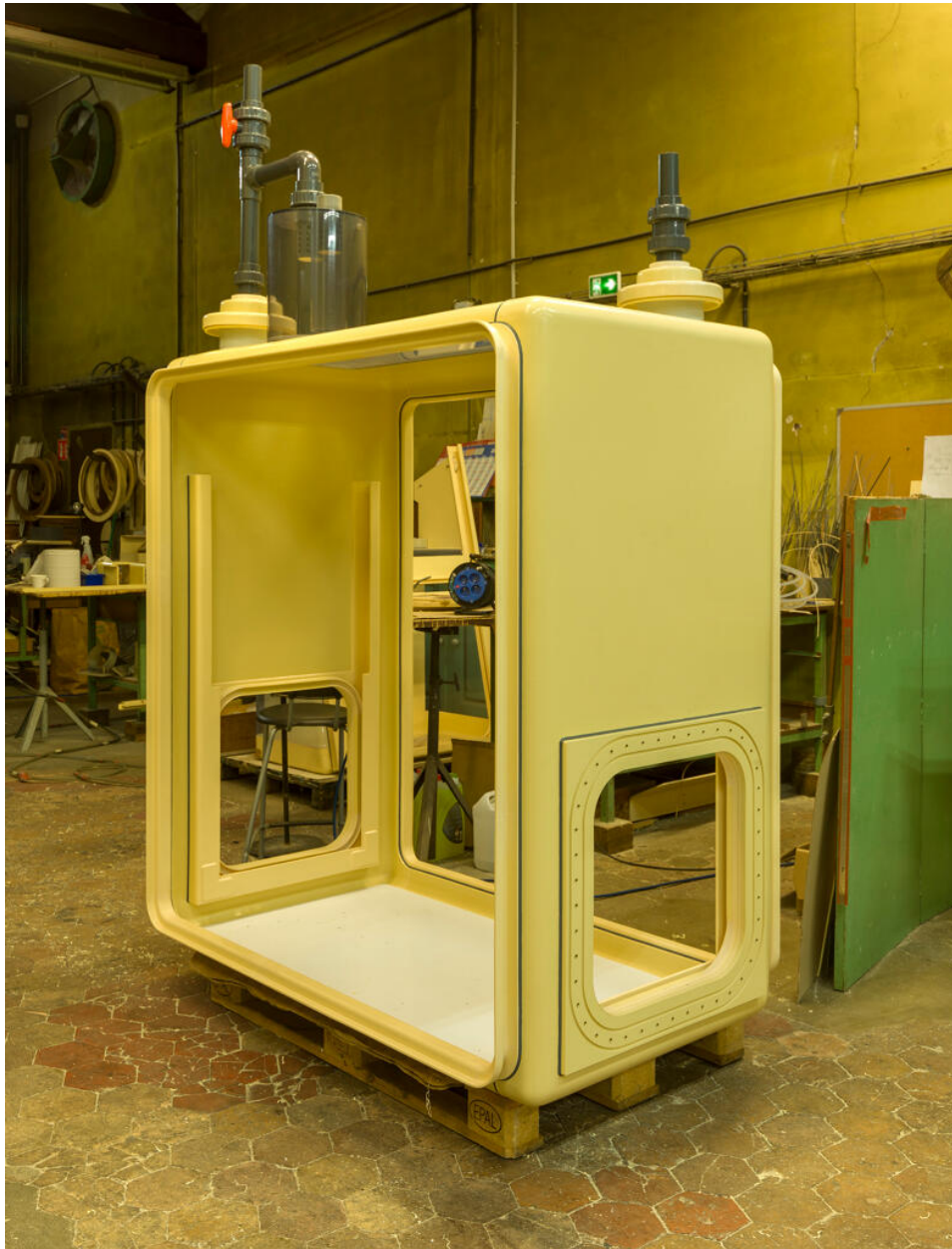
Enceinte de confinement en PVC.
