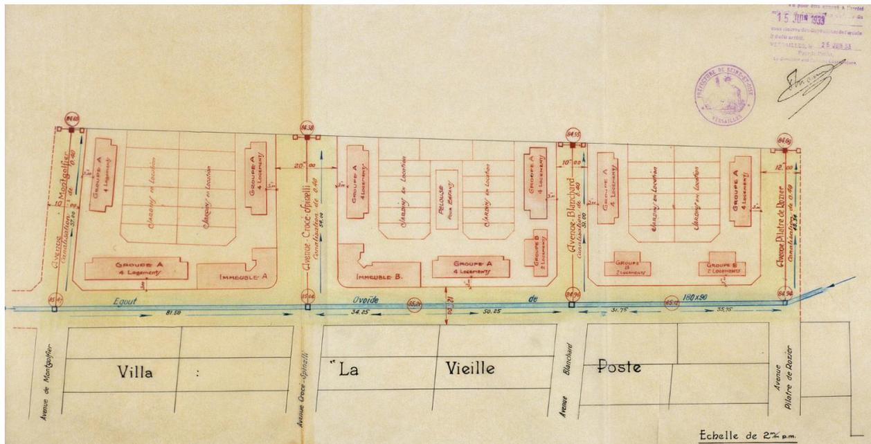
Plan d'ensemble du lotissement, établi sur le plan de nivellement dressé par L. Poussin, géomètre à Juvisy. Ce lotissement, situé à côté de la Villa La Vieille Poste, a été approuvé par arrêté préfectoral du 15 juin 1933.
