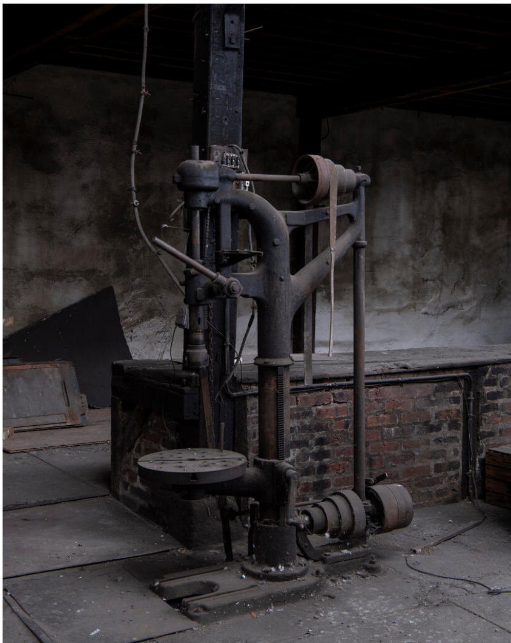
Intérieur de l'atelier des forges. Perceuse à colonne.
