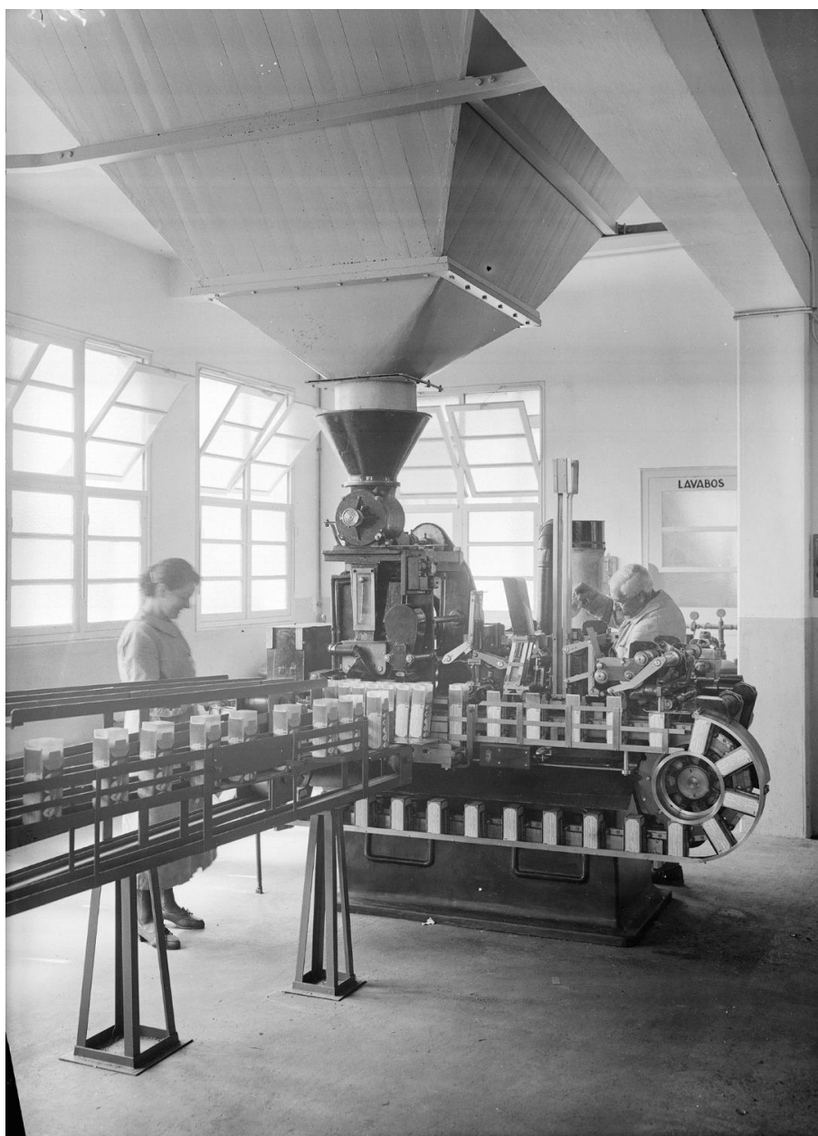
Machine remplissant les boîtes de tisane en vrac en fonctionnement.
