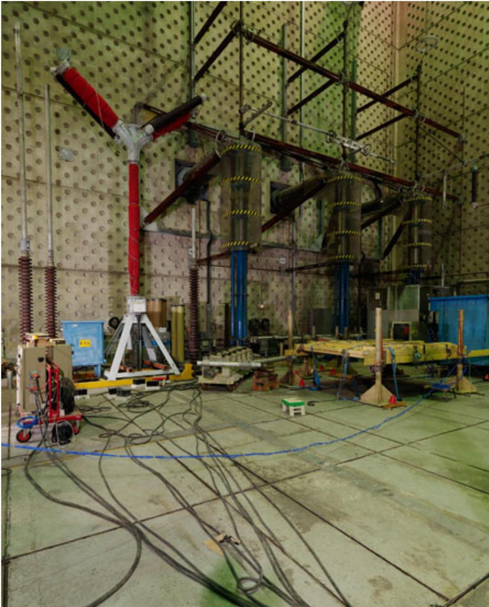
Intérieur d'un Hall STGP (Station d'essais grande puissance). Parois de béton armé de 40cm d'épaisseur alvéolé pour résister a des déflagrations de 10 kg de TNT.
