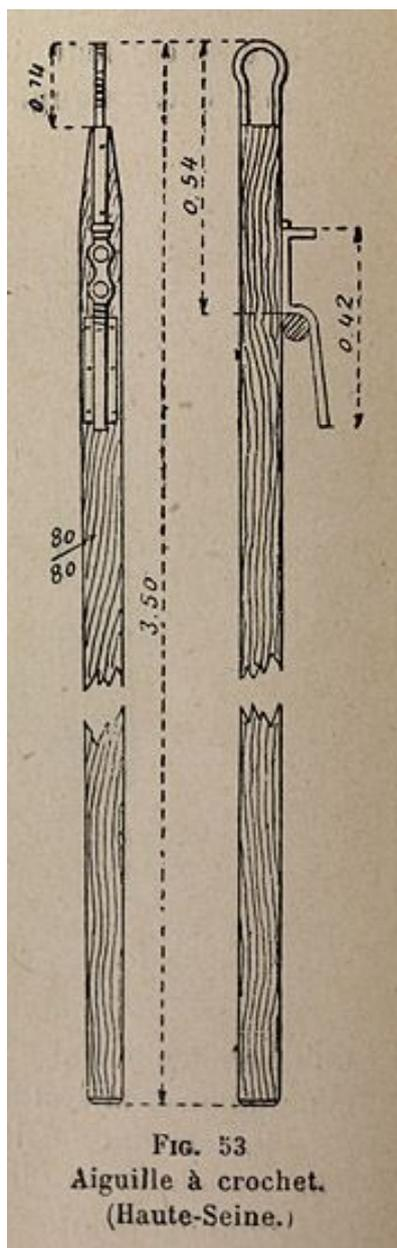
Barrage éclusé. Dessin d'une aiguille à crochet (Haute Seine).Fig. 06. Aiguille à crochet (Haute Seine). Tiré de : Notions de navigation intérieure / M. Fourrey. Paris : Ecole spéciale des travaux publics, 1929.
