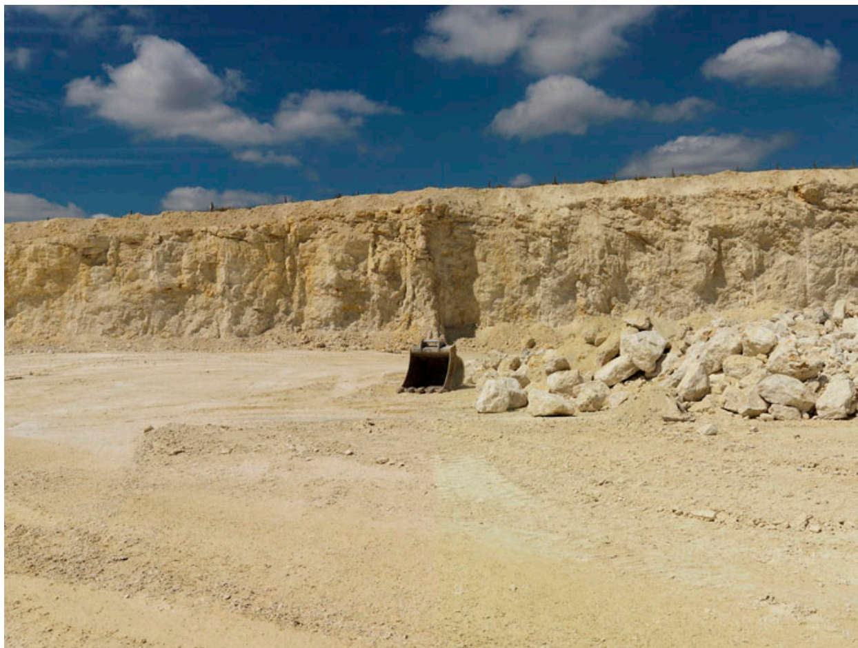
Front de carrière. Formation calcaire de Champigny et de Chateau-Landreau. Dépôt lacustre.
