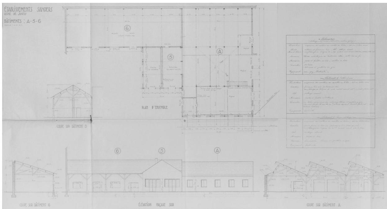
Elévation et plan des bâtiments A (stockage, imprimerie, laboratoire, cantine, garage), 5 (réfectoire, atelier) et 6 (hangar, stockage), détruits par le bombardement du 2 juin 1944. L'ossature des bâtiments A et 6 est constituée de fermes en bois et poteaux sur dés avec remplissage de briques, sur fondations en maçonnerie de moellons. Des sheds couvrent le bâtiment A.
