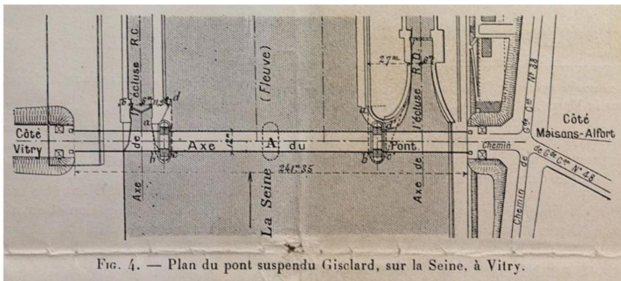
FIG. 4. — Plan du pont suspendu Gisclard, sur la Seine, à Vitry.
