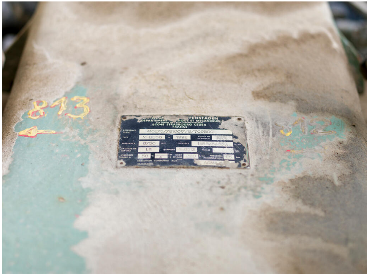
Unités Est - Zone FCC (Unité 651). Compresseur turbo-alternateur, autrement dit compresseur à récupération d'énergie. Plaque signalétique du réducteur Graffenstaden.
