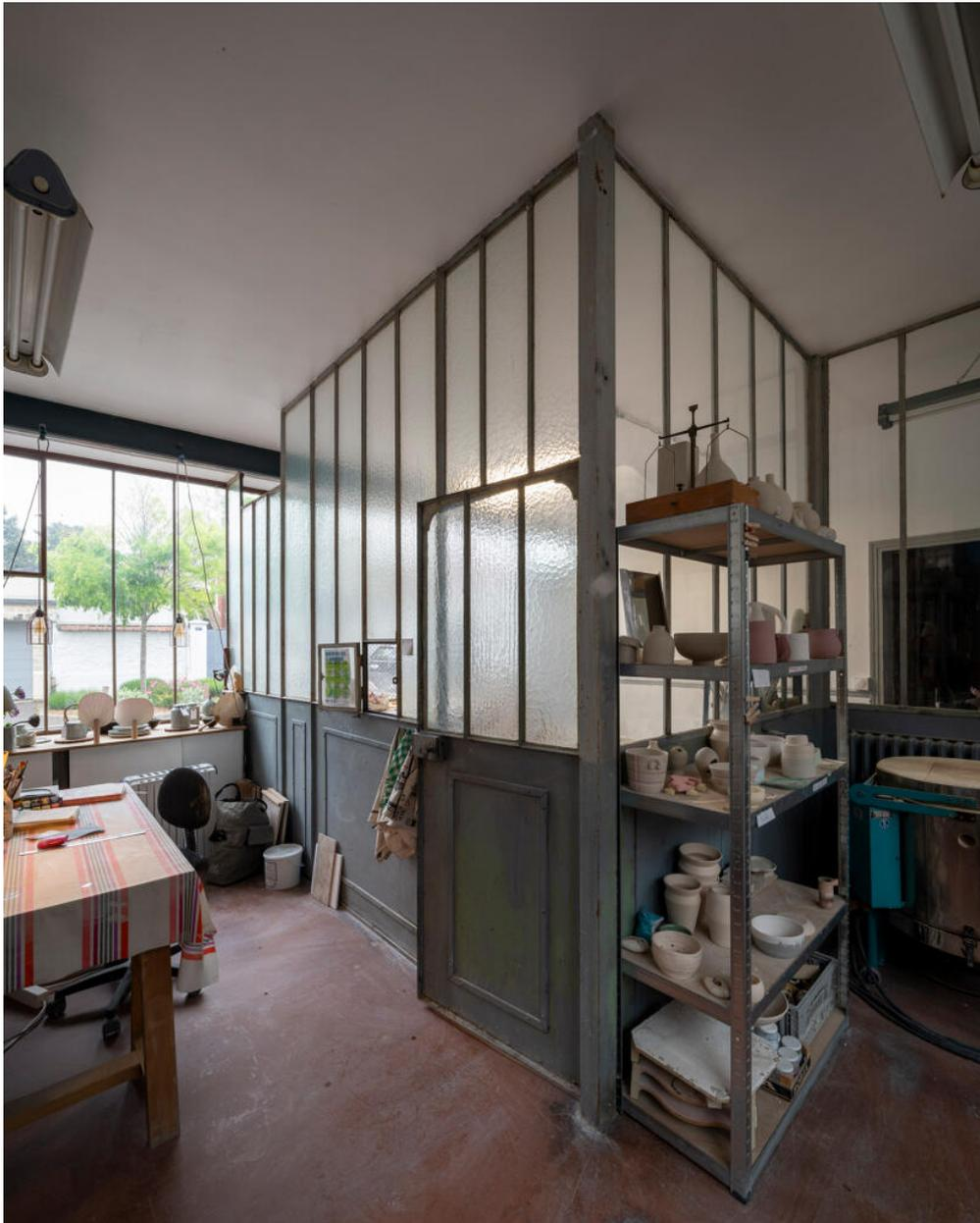
Atelier Danièle Wolff Céramiques. À gauche, le poste modelage et émaillage. À droite, le four électrique, « cœur de l'atelier », où chaque pièce passe en cuisson. À côté, les pièces en attente d'émaillage, ou émaillées et prêtes à cuire. En bas de l'étagère, les plaques réfractaires utilisées pour créer des étages dans le four. En haut de l'étagère, la balance de précision, utilisée au moment du travail de recherche pour la création des émaux.
