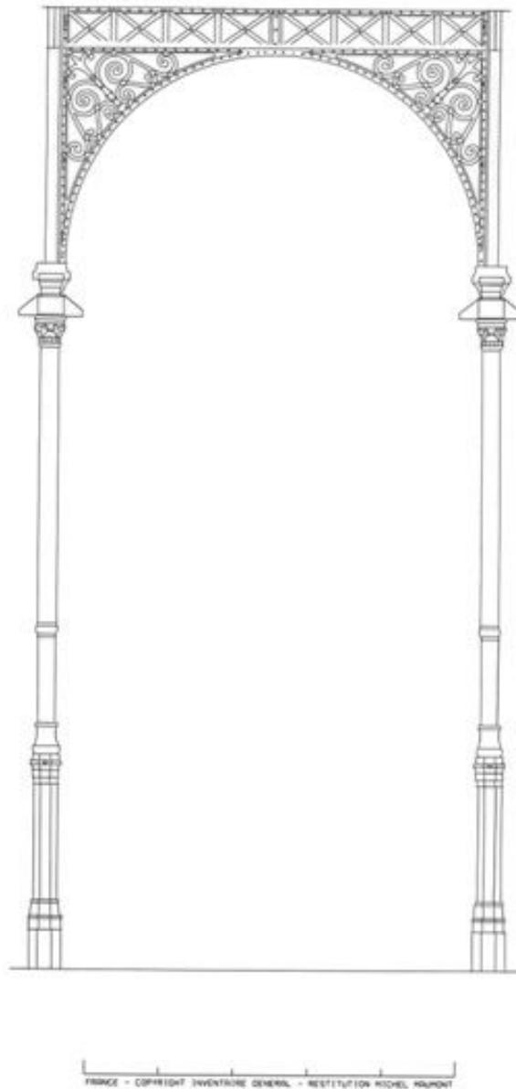
Elévation d'une arcade longitudinale. Restitution photogrammétrique, 1983.
