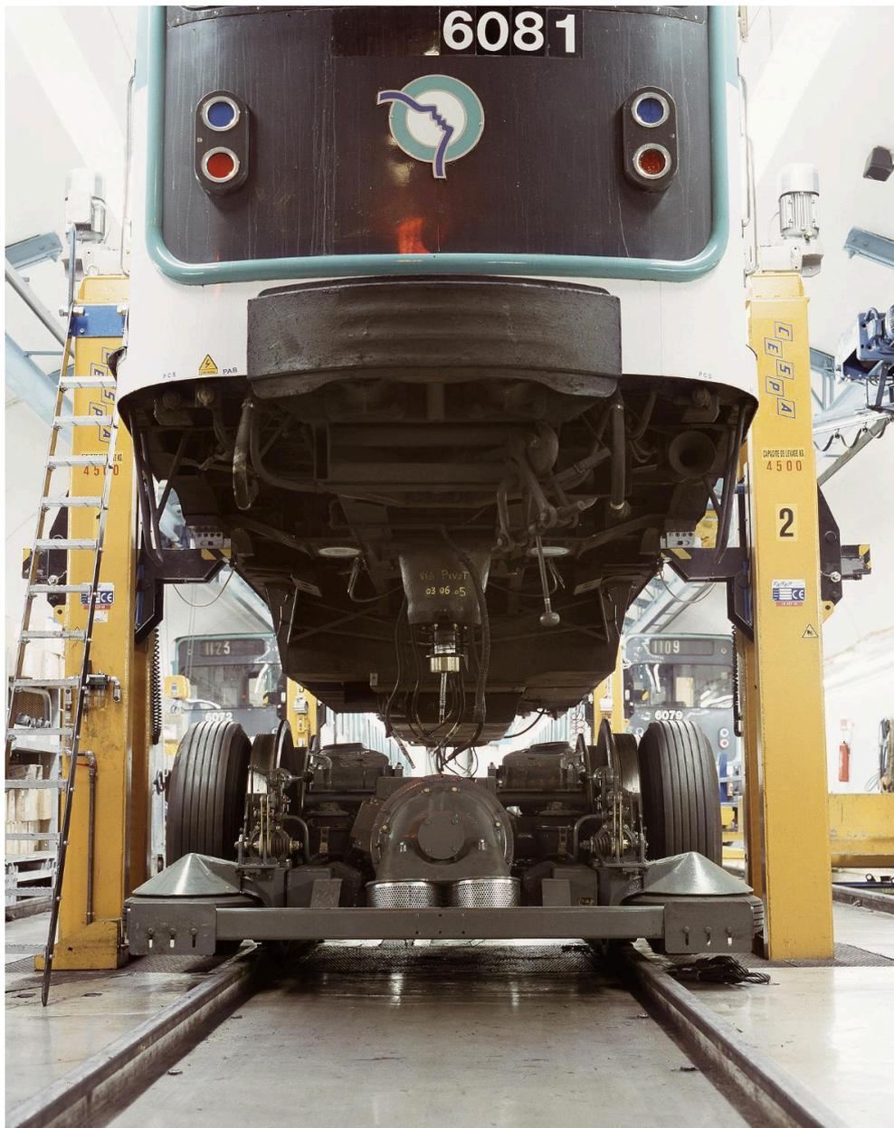
Echange de bogie pour révision générale. Au centre, l'axe permettant de fixer le bogie à la caisse.
