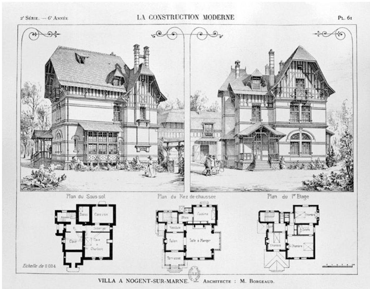
Plans du sous-sol, rez-de-chaussée et premier étage; élévations latérale (à gauche) et antérieure (à droite) d'une maison projetée par Borgeaud, architecte à Saint-mandé. Tiré de : La construction moderne, 1900-1901, t.6.
