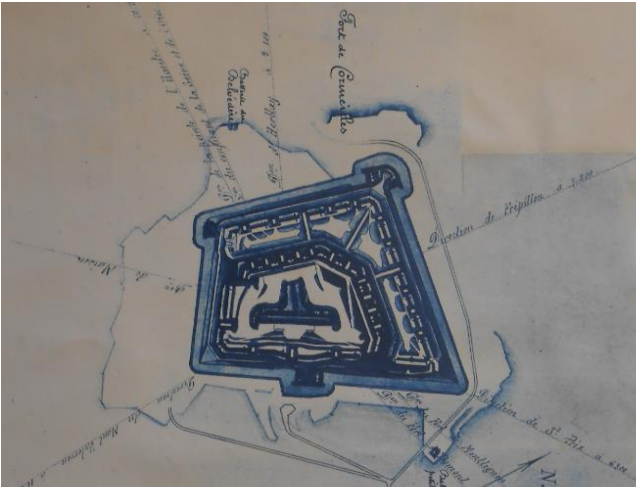
Au nord-est du fort, sur le front de tête, se trouve une caponnière , casemate basse placée en fond de fossé, en saillie sur l'escarpe et en bout d'alignement. Elle est double, car elle bat deux fossés.
