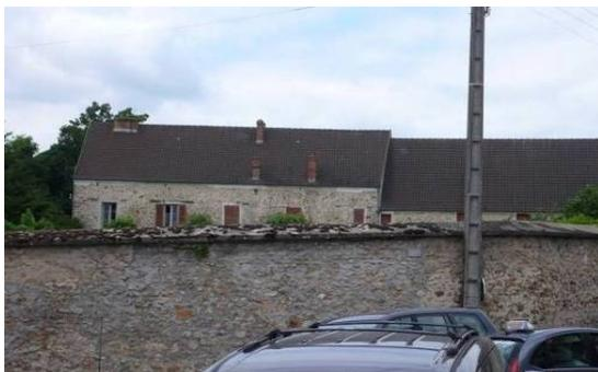
*ECH19 : logis et bâtiments agricoles « ante-cadastres » construits en meulière et renforcés par des chaînages d'angle en blocs de grès*
