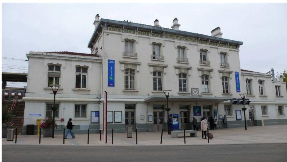
*Le bâtiment des voyageurs de la gare de Brétigny-sur-Orge possède un corps central de deux étages carrés et de cinq travées. La modénature est composée d'éléments de décor en plâtre et de carreaux de faïence situés à la hauteur de la corniche. Le corps central est flanqué de deux ailes symétriques. L'aile septentrionale a fait l'objet d'une extension.*
