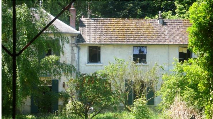
*BAL01 : à gauche, l'ancien logis coiffé d'un toit en pavillon recouvert d'ardoises. La façade possède une modénature de plâtre composée d'un chaînage d'angle et d'une corniche.*
