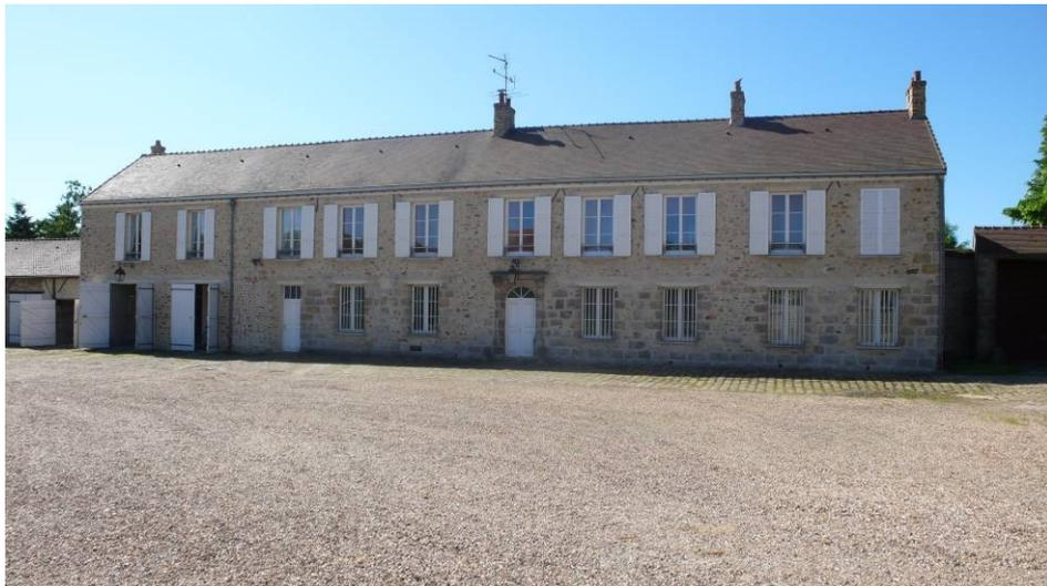
VEG11 : logis construit en meulière et blocs de grès. La porte cintrée est surmontée d'une corniche et encadrée de pilastres en grès qui se terminent par des chapiteaux.
