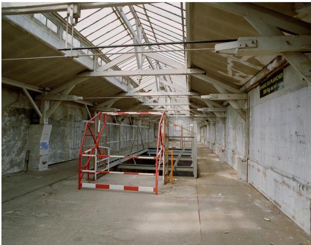
Magasin pièces détachées de l'usine Rateau. Le plancher (appelé "plancher petit outillage") et la trémie ont été aménagés par l'entreprise Guitel-Etienne. Aux deux extrémités de la trémie grillagée, ont été installées deux barrières de sécurité pivotantes : une fois la palettes de carton déposée à l'entrée de trémie, la cage est basculée, et la méchandise récupérée par des charriots élévateurs.
