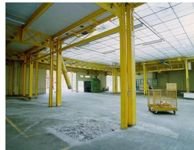
Intérieur de l'ancien atelier de chaudronnerie de l'usine Rateau, devenu magasin de stockage des pièces détachées puis atelier de montage de l'usine Guitel-Etienne. Le "plancher caoutchouc" a été mis en place vers 1968-1970 afin d'augmenter la capacité de stockage du magasin pièces détachées. A gauche, le conduit en PVC permettait d'acheminer les pièces en plastique depuis le premier étage jusqu'au rez-de-chaussée. Au fond, une cabine de peinture.
