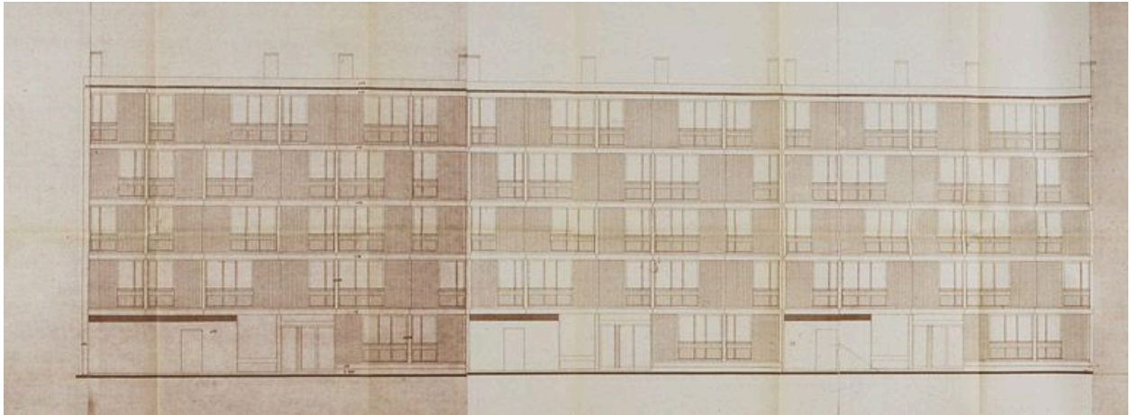
Bâtiments L (longs) : façade sur jardin d'un bâtiment R+4 desservis par 7 escaliers. (AM Vigneux-sur-Seine, 80 W 3-4)
